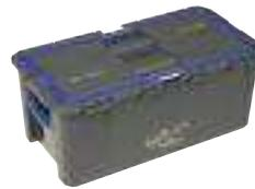
Compact 37 inklusive 7 Einsätzen und Trennwänden für die Unterteilung des Koffer-Innenraumes. Gewicht 3,7 kg. Werkzeugkoffer aus Polypropylen (PP) hergestellt. Flexible Raumaufteilung durch die Verwendung von Einsätzen. Rollen und Tragegurt können montiert werden.
