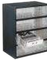
Schubladen-Schrank mit 8 transparenten Schubladen, Typ 250-2. Jede Schublade kann in 4 Fächer unterteilt werden. Magazin hergestellt aus Stahl, Schubladen aus Polypropylen (PP).
