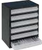
Schubladen-Schrank mit 6 transparenten Schubladen, Typ 250-3. Jede Schublade kann mittels Einsätzen unterteilt werden. Magazin hergestellt aus Stahl, Schubladen aus Polypropylen (PP).
